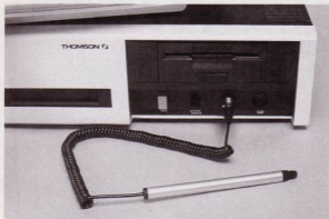
Le crayon optique - de conception nouvelle - se connecte sur la face avant de l'unité centrale.
